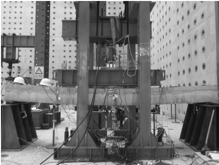
图2 试验加载装置
