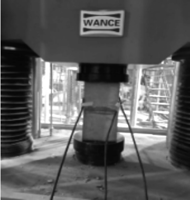
图 7 轴心抗压强度加载设备
