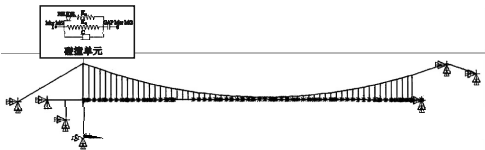
图 2 悬索桥主、引桥梁端碰撞的有限元模型
