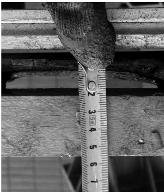
图14 顶部木板底面炭化层测量
