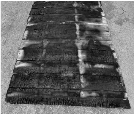
图13 顶部木板炭化表面
