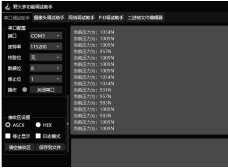
图 13 上位机串口显示界面
