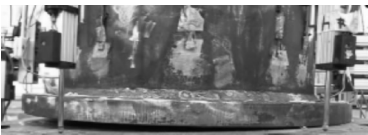
(g)RP3-DT43-PT44-BP20试验变形及开口状态
