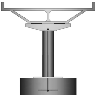
图1 自复位桥墩结构示意图
