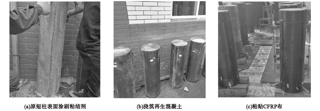
图 2 试件的加固及养护
