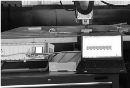
图 2 测力仪测量切削载荷数据
