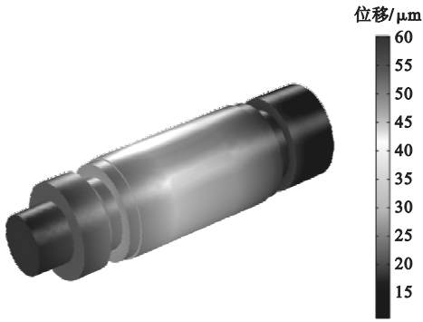
图 5 9 000 r/min 时主轴系统稳态热位移图
