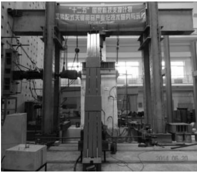
图 3 试验加载装置设计
