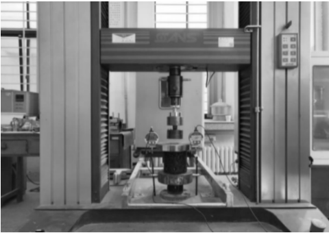
图 3 间接拉伸试验
