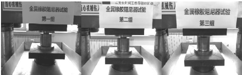
图2 静态压缩试验
