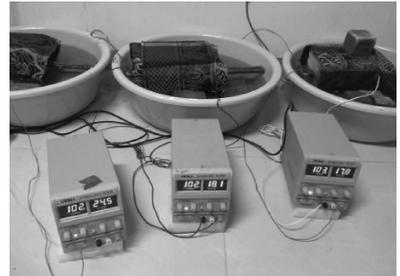
图 3 钢筋快速锈蚀装置
