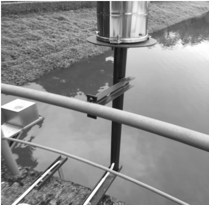
图 3 雨量计安装示意图 Fig. 3 Schematic diagram for installation of rain gauge
