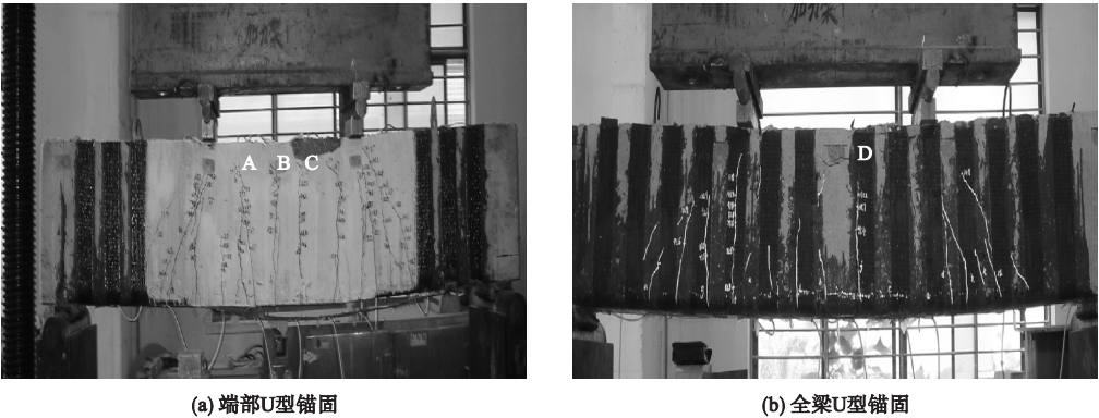
图 5 试验梁的裂缝分布及扩展 Fig. 5 Crack propagation of the specimens
