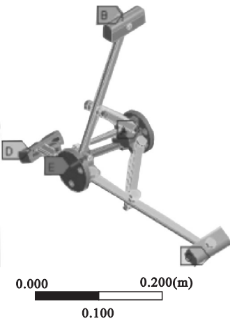
图10 固定约束和力载荷
