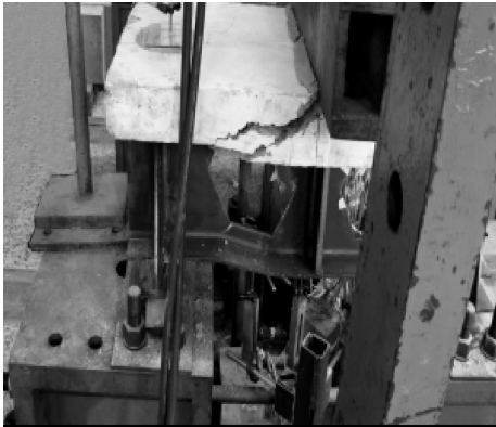
图 3 试件 FZL 破坏现象
