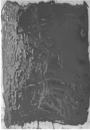
图 3 低温蒸残获取乳化沥青 - 水泥胶浆残留物
