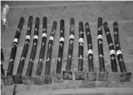
图3 试件破坏形态图
