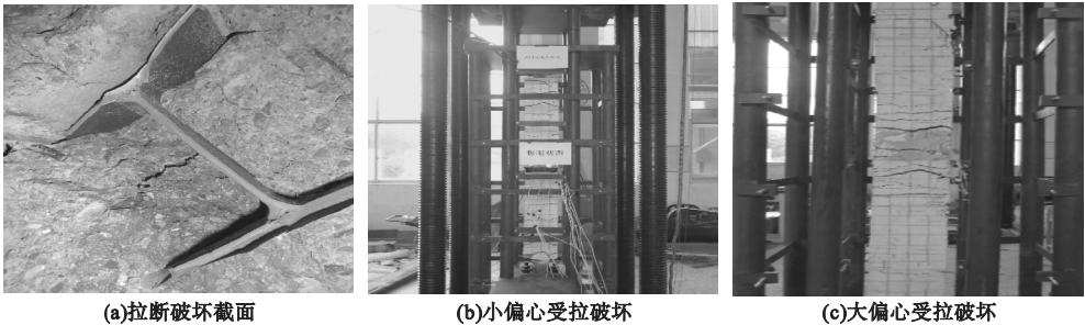
图 3 试件主要破坏形态
