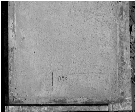
图 8 聚丙烯体积质量为 1.3 kg/m 3 试件破坏形态
