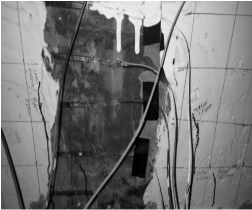
图 8 无粘结预应力 RPC 梁破坏形式
