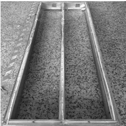
图 10 墙体内部墙架柱
