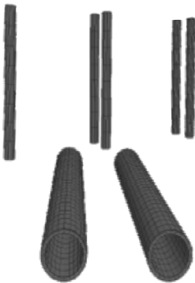
图2 盾构下穿时隧道结构和桥桩基础结构
