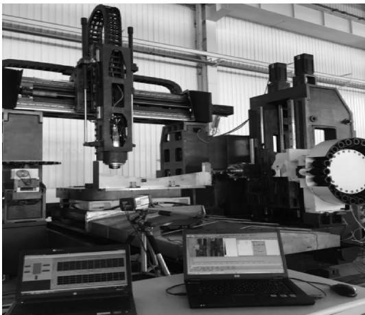
图3 主轴系统温度及热误差现场测试环境
