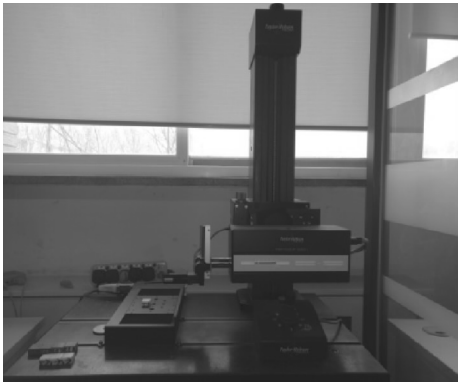
图1 Surtronic25 型粗糙度仪 Fig.1 Surtronic25 roughness meter
