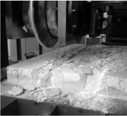
图 15 双滚刀破岩试验图
