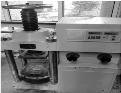
图1 恒加载压力试验机
