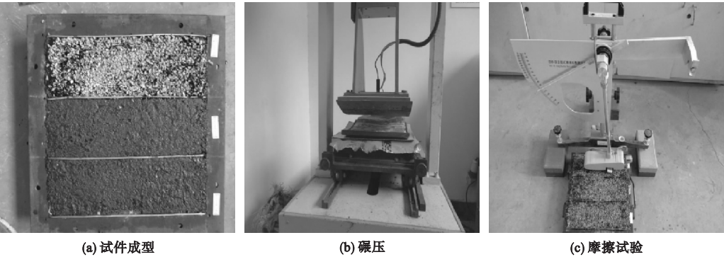
图4 抗滑性能试验
