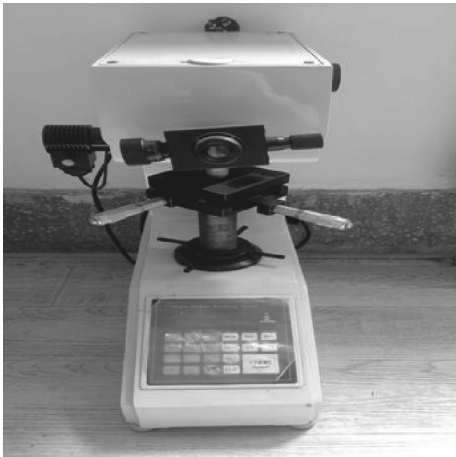
图1 显微硬度仪
