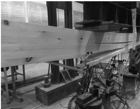
(a) 受拉区底层板受拉破坏
