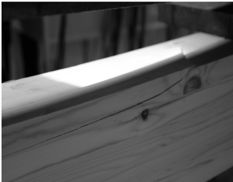
(c) 受拉区木材拉断受压区开木材褶皱破坏
