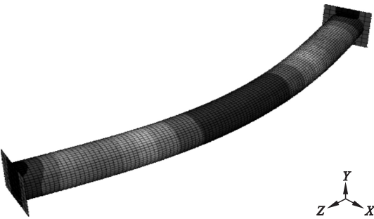
图 2 一阶屈曲模态 Fig. 2 First buckling mode
