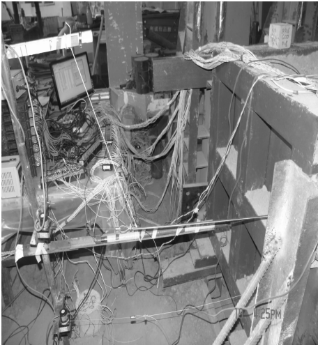
图 5 箱体及管道位移测量装置
