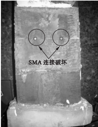
(b) 型钢侧破坏面
