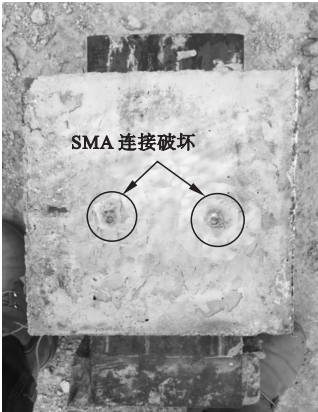
(a) 混凝土侧破坏面
