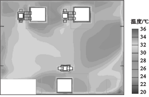
图 17 Y = 1.2\text{ m} 截面处温度分布 Fig. 17 Temperature distribution of Y = 1.2\text{ m}
