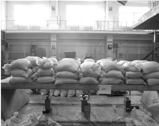
(a) 预应力带肋板实际加载
