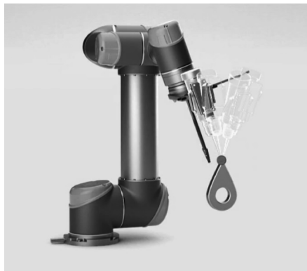
图1 UR 机器人 TCP 标定
