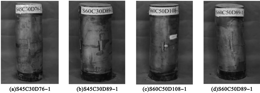
图 3 典型试件破坏形态
