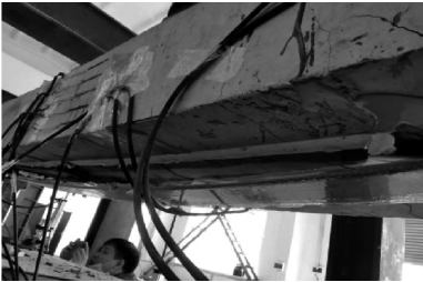
图 6 试件 PS1 加载形态
