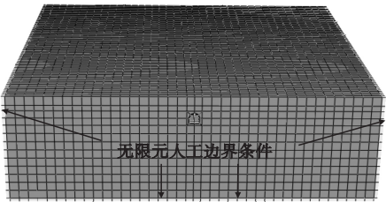
图4 模型两侧设置无限边界
