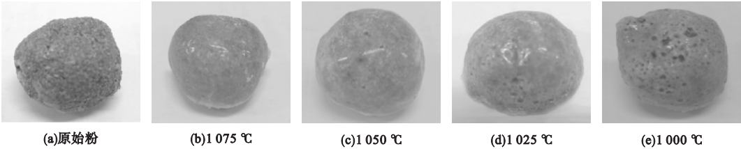
图 6 不同温度烧结陶粒的形貌
