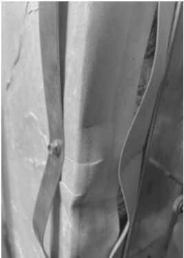
(b)钢板带屈曲、牛皮纸被撑开
