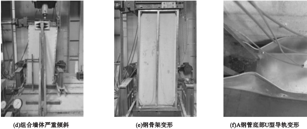
图4 试件 W3 破坏形态
