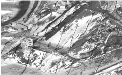
图7 空中技巧赛道土方阶段数字模型
