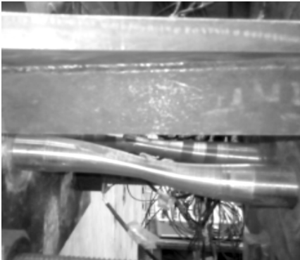
图6 阻尼器破坏时的形态
