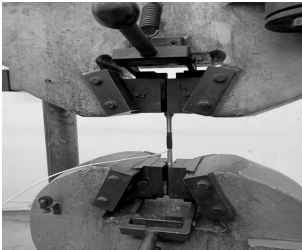
(a)试件尺寸 (b)试验加载系统示意图 图 2 钢材材性测试
