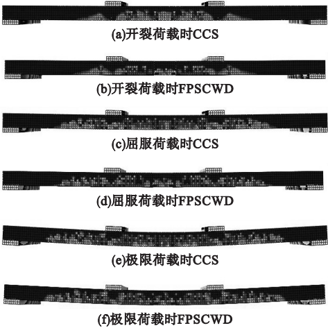
图 6 不同荷载 CCS 和 FPSCWD 板侧塑性损伤云图对比
