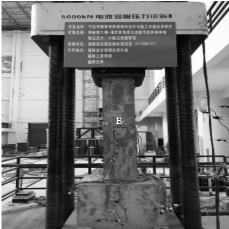
图 4 加载装置布置图
