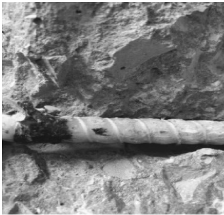
(b)肋间混凝土剪切破坏
