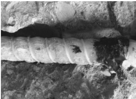
(b)肋间混凝土剪切破坏
