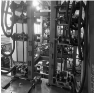
图2 钢筋骨架自动成型生产线
