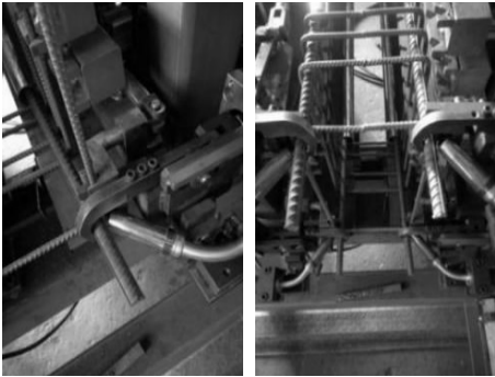
(a)主筋定位 (b)箍筋定位 图1 试件焊接夹持图
