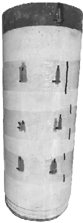
图 2 试验管道应变片布置
