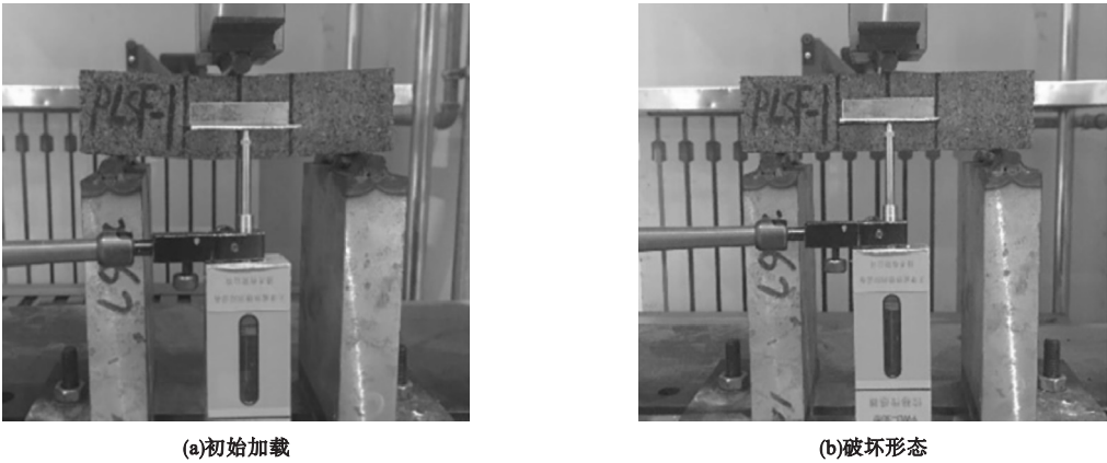
图 1 三点弯曲试验
