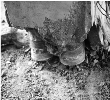
图8 FSW2 试件墙根处破坏图
